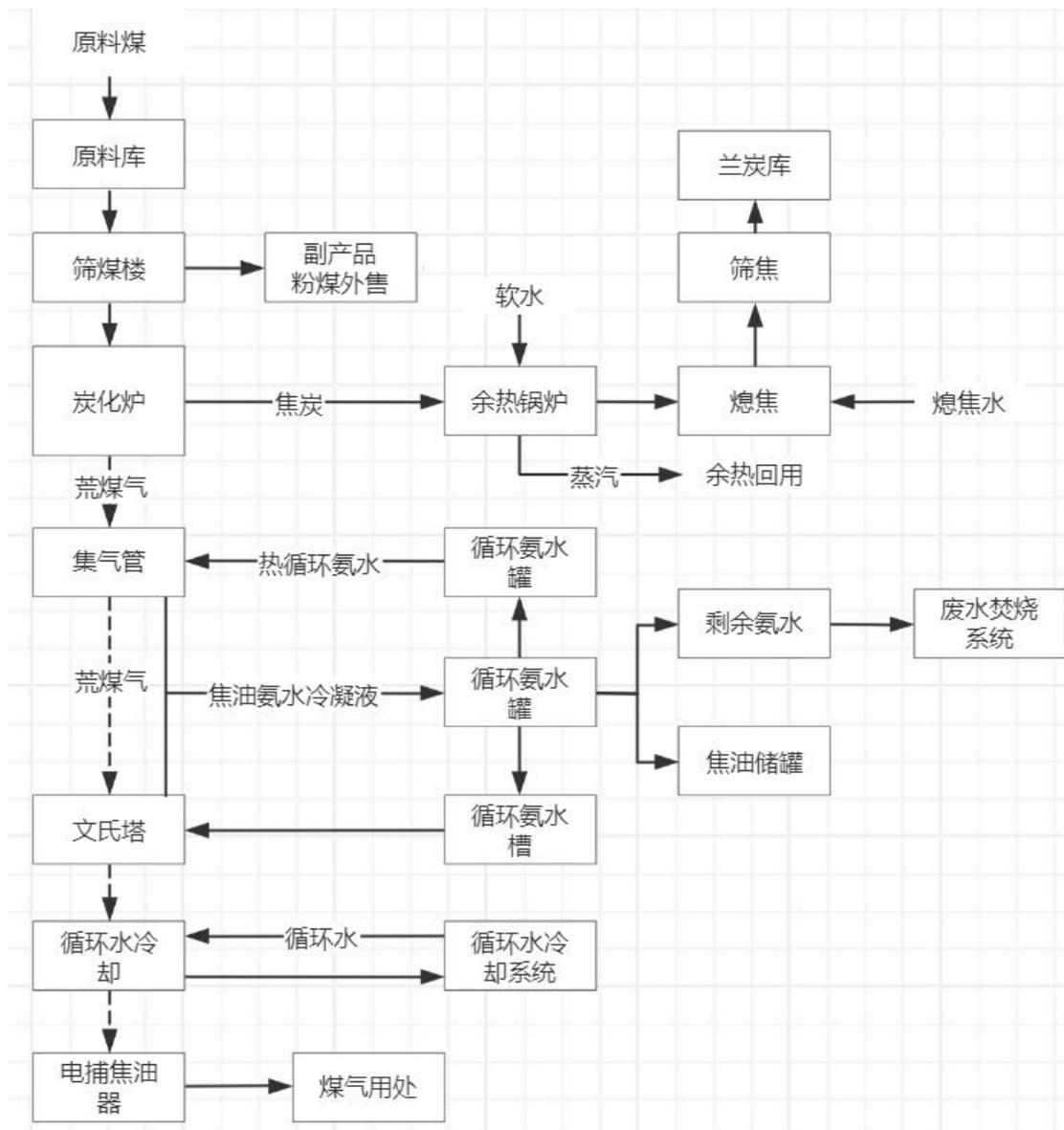
图 3.5-2 提质煤总体工艺流程
